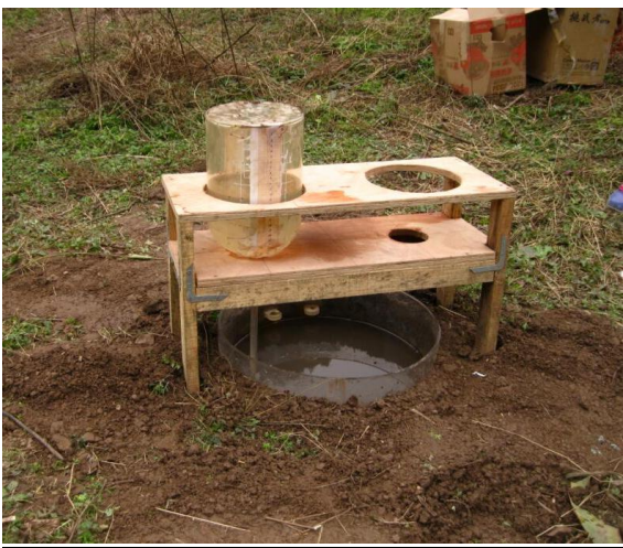
图 6.2-3 渗水试验现场照片
