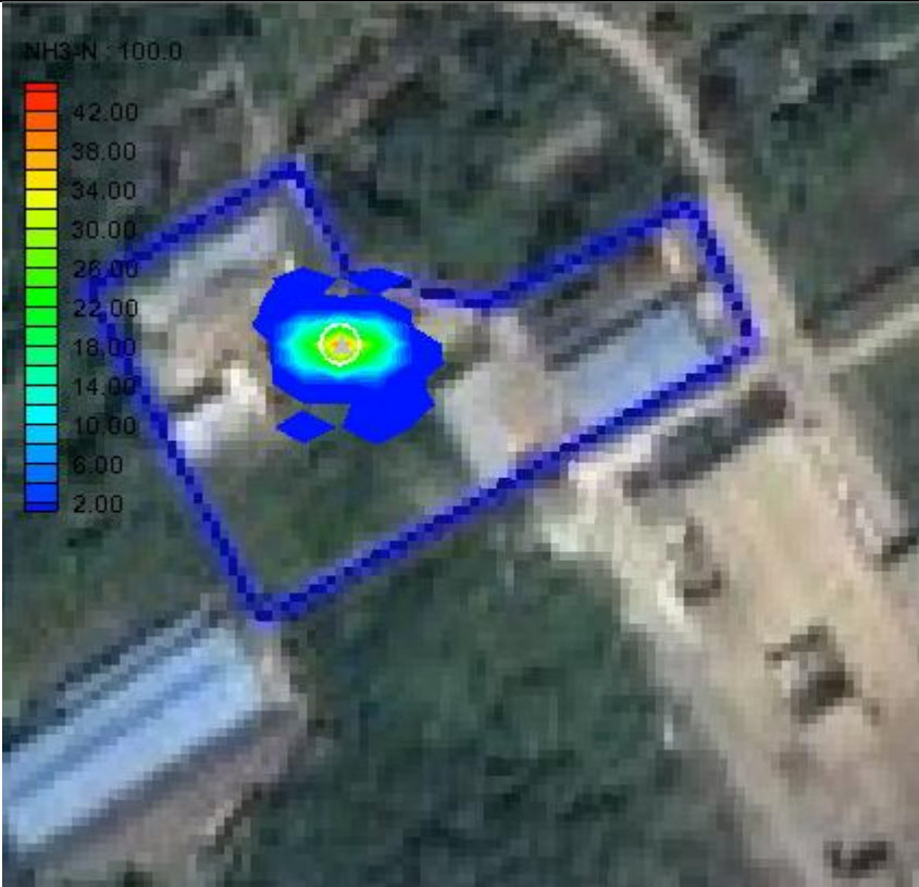
图 6.2-13 渗漏 100 天后，氨氮影响范围和运移距离
