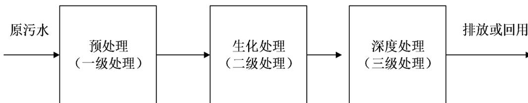
图 5-1A EIC-MBR工艺污水处理流程简图
