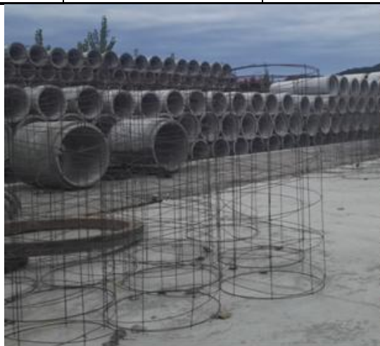
涵管钢筋骨架
