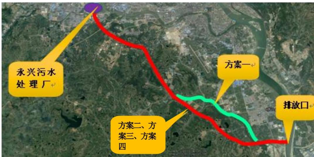
图 1-4 永兴污水厂尾水排放管方案比选示意图
