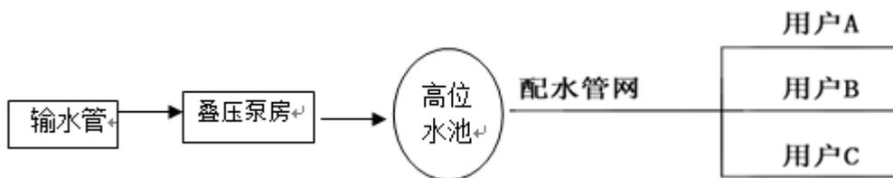
图 3-4 叠压加压式供水工程工艺流程图
